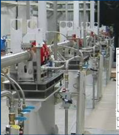
255MeV 電子線型加速器 ・全長30m
