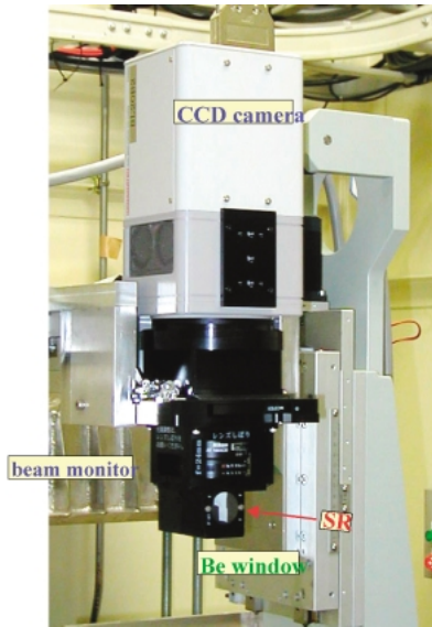
Fig. 7 可視光変換ユニット「ビームモニター」(浜松ホトニクス製 AA40P (f=2.4mm))・「CCD カメラ」(同社製 ORCA II-ER (f=35 mm)) の組み合わせ。SPring-8 BL20B2 に設置された様子。
